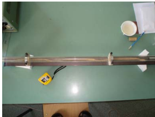
Слика 26. Три трбуха стојећег таласа у Кундтовој цеви
