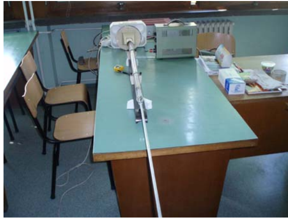
Слика 25. Кундтова цев са апаратуром
