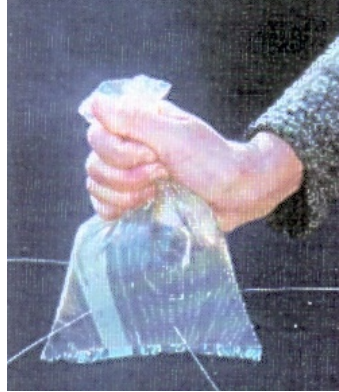
Slika 22 Demonstracija Paskalovog zakona
