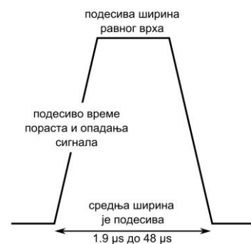
Слика 2.6 Троугаони (трапезоидни) сигнал који се користи у дигиталним анализаторима.
