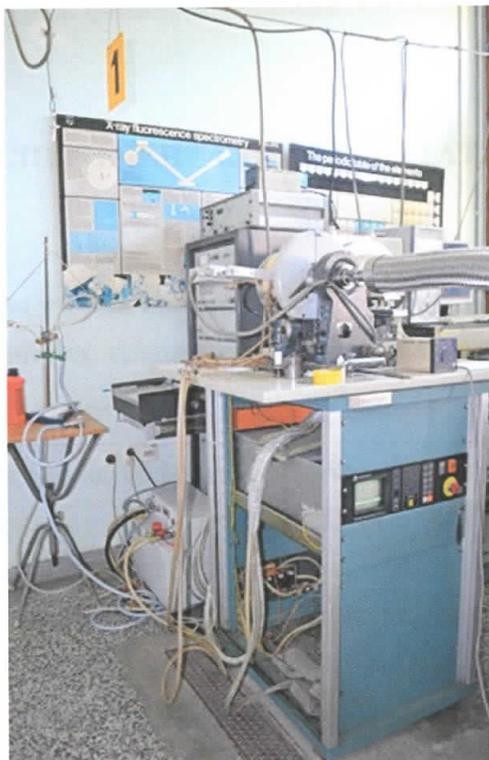
**Слика 25.** Фотографија поставке апаратуре за испитивање узорака методом дифракције X-зрака
