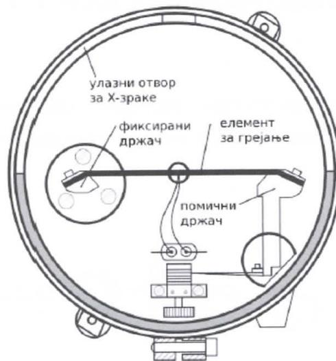
**Слика 24.** Високотемпературна камера - комора дифрактометра
