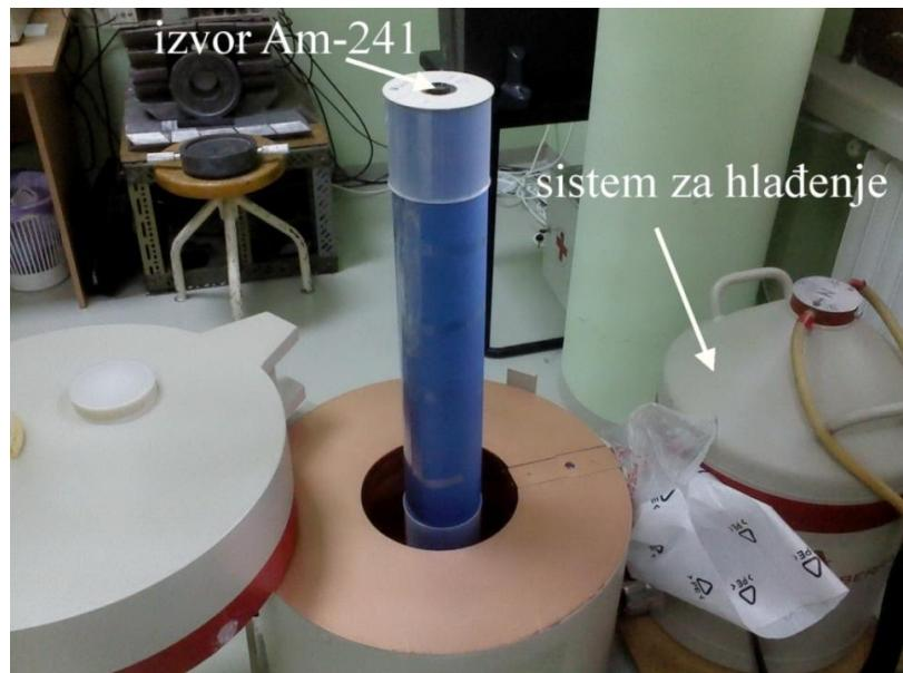
*Slika 11. Spoljašnji izgled detektora proizvođača Canberra sa olovnom zaštitom i eksperimentalnom postavkom*
