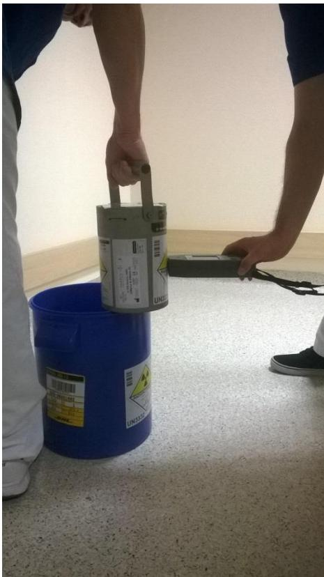
Slika 17. Mjerenje doze na površini kontejnera
