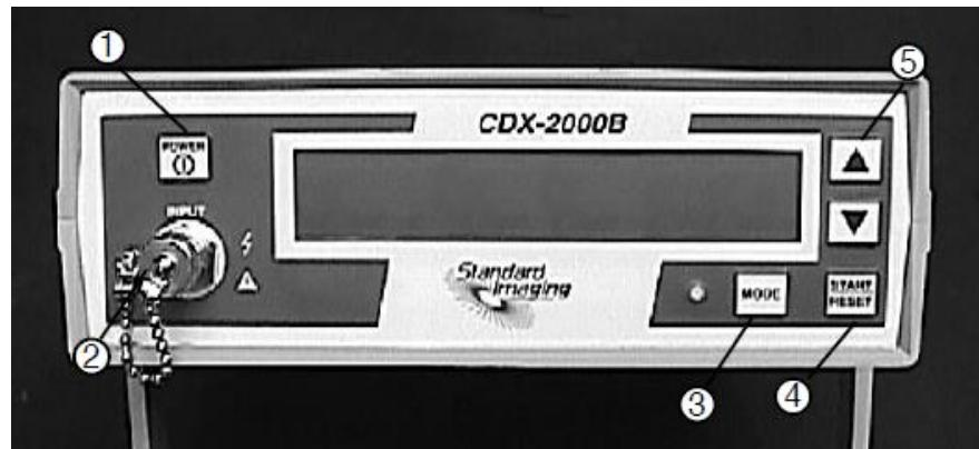
Slika 26. Elektrometar
