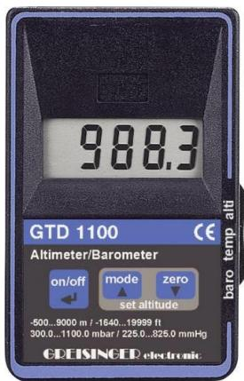
Slika 28. GTD 1100 barometar
