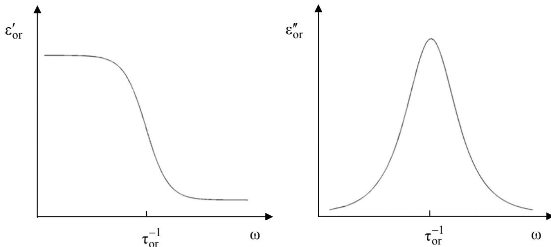
**Slika 6.1** - Disperziona zavisnost realnog i imaginarnog dela relativne permitivnosti pri dominirajućoj orijentacijskoj polarizaciji
