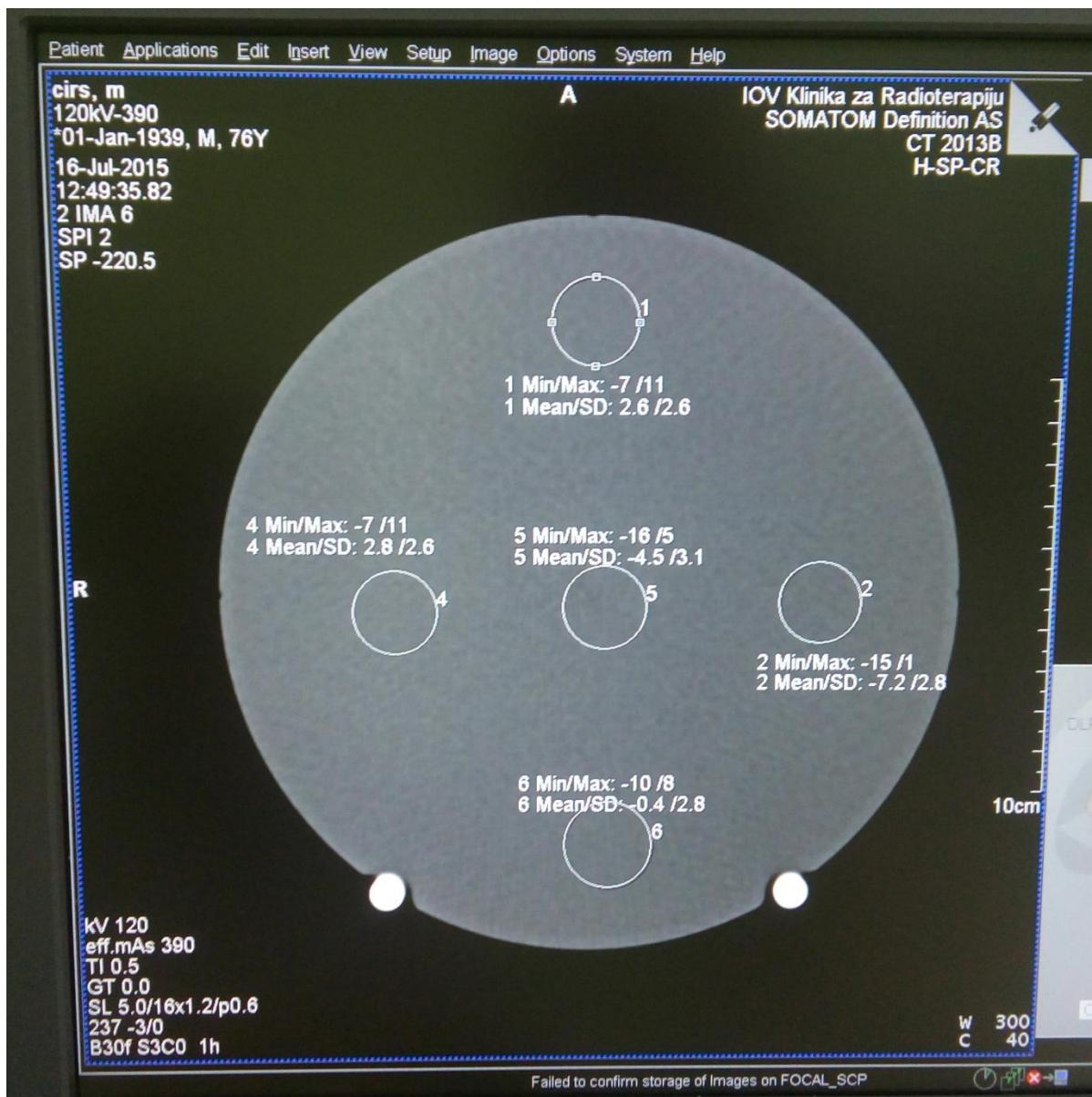
Slika 28. Prikaz homogenosti pri naponu od 120 kV i struji od 390 mA
