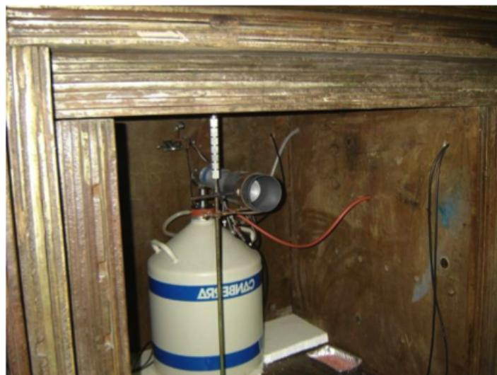
Slika 6.4: HPGe detektor u gvozdenoj zaštiti
