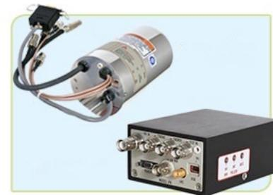
Slika 4.4: Predpojačavač za HPGe detektor. Za uske (levo) i zaobljene (desno) kriostate
