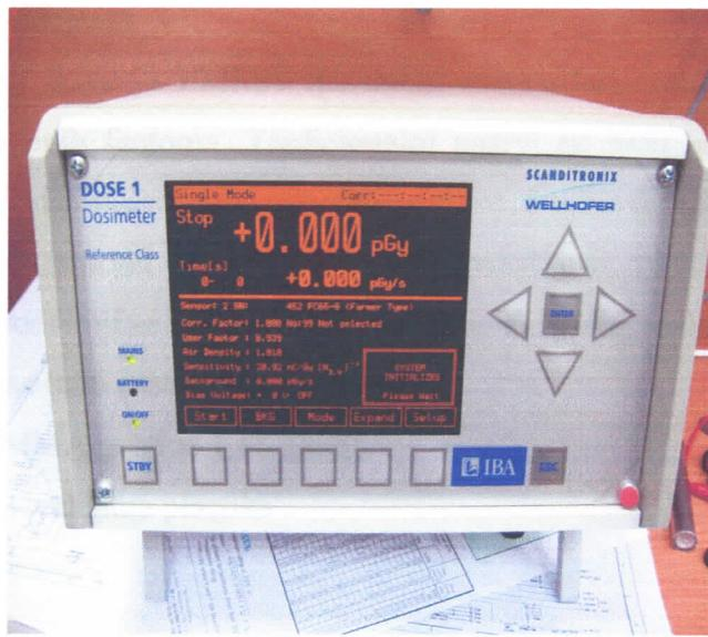
Slika 3-6 Elektrometar Scanditronix Wellhofer Dose 1
