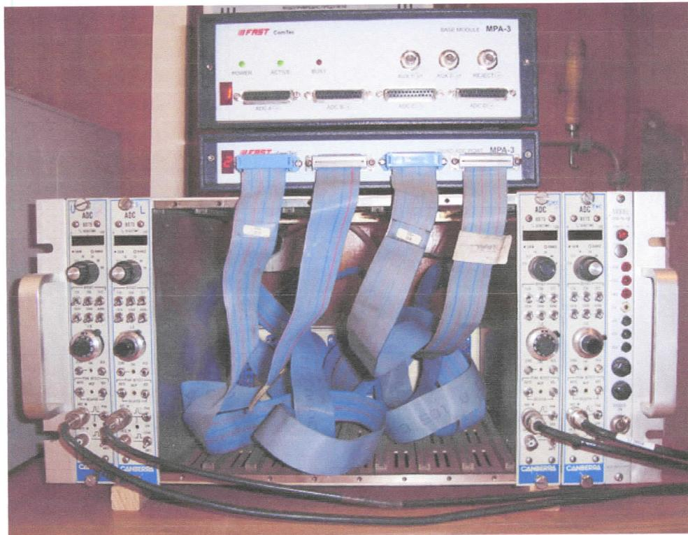
**Slika 5.4.** Fotografija baznog modula, ADC port modula i 4 ADC
