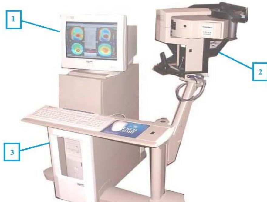
Slika 10: Komponente Bauš i Lomb kornealnog topografa
