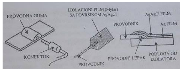
Слика 2.19. Шематски приказ флексибилних површинских електрода
