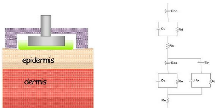
Слика 2.12. Општа еквивалентна електрична шема површинских електрода. Гел који се користи код неких електрода обезбеђује бољи контакт електроде са кожом
