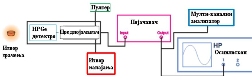
Slika 12: Shematski prikaz komponenata detektorskog sistema sa germanijumskim detektorom[3].
