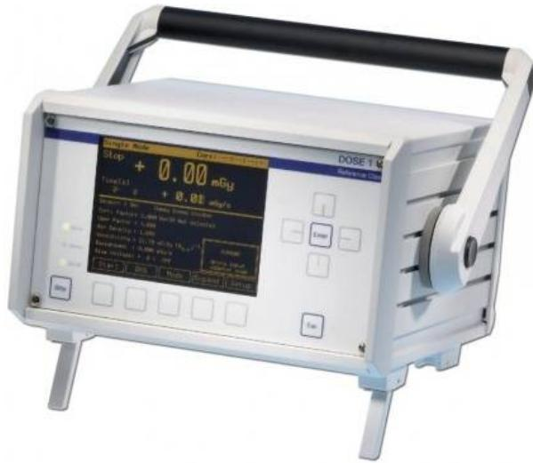
Slika 2.3. Elektrometar Wellhofer Dose 1 [15]
