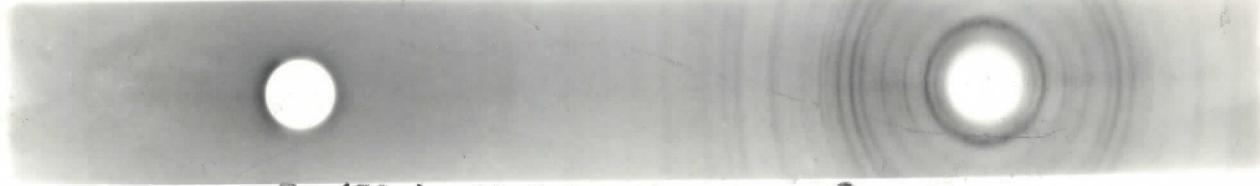
$\text{Fe}_3(\text{PO}_4)_2 \cdot 8\text{H}_2\text{O}$  Zagrevan na  $85^\circ\text{C}$  - 1 h.
