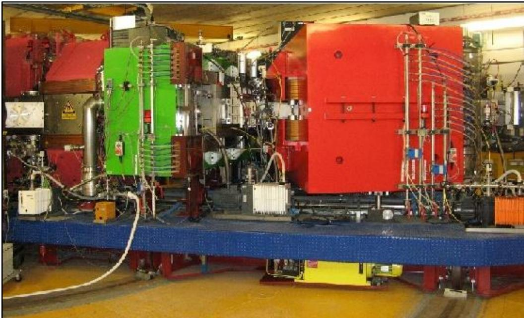
Slika 2.2: Fotografija VAMOS spektrometra koji se sastoji od (s leva na desno): dva kvadrupola, Vinovog filtera, dipola kao i mali deo komore u kojoj su smešteni detektori fokalne ravni
