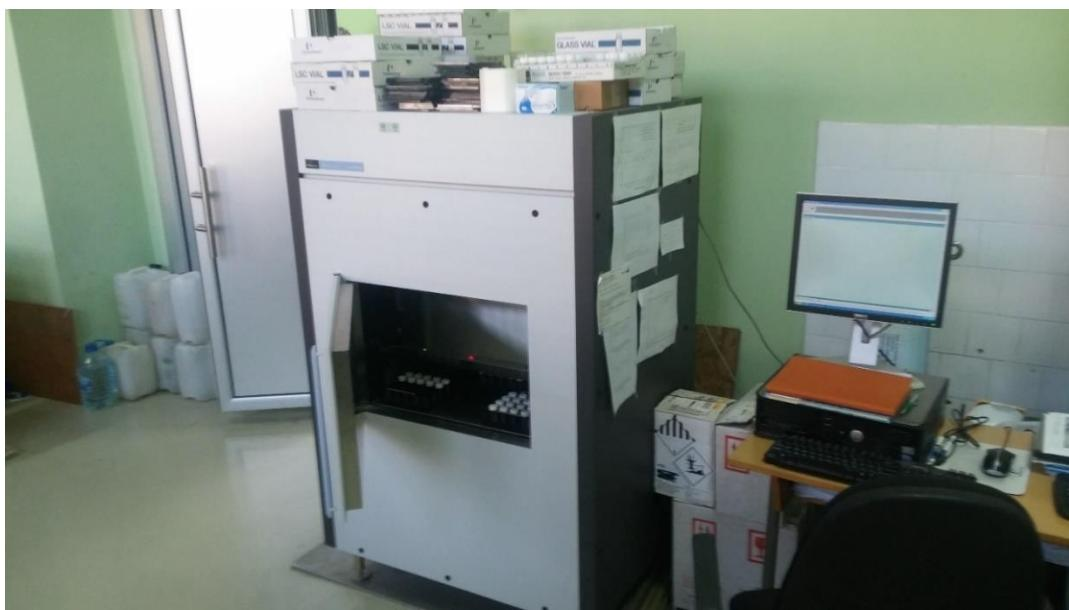
**Slika 3.13 Tečni scintilacioni spektrometar Quantulus 1220™**
