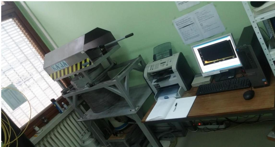
**Slika 3.1 Gama spektrometrijski sistem sa oznakom K u Laboratoriji za Nuklearnu fiziku PMFa u Novom Sadu**
