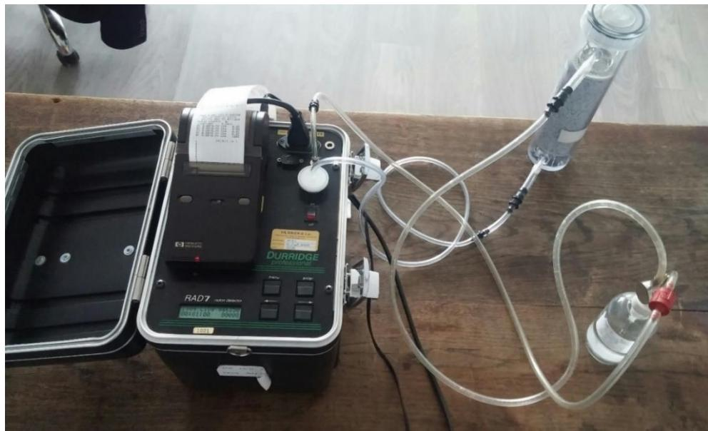
Slika 3.7 Korišćeni alfa spektrometar RAD7
