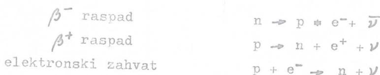
Beta minus ( $\beta^-$ ) raspad dogadja se kod jezgara kod kojih je neutron u višku. U jezgru koje pretrpi  $\beta^-$  raspad neutron se transformiše u proton,  $\beta^-$  česticu i antineutrino. Neutron koji je pre raspada bio u jezgru, posle raspada postaje proton koji takođe ostaje u jezgru. Prema tome menja se i jezgro i atom
