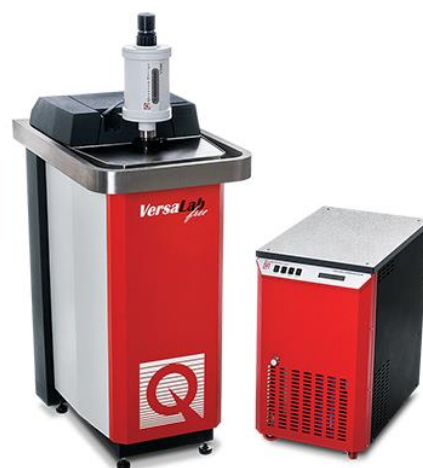
Slika 5.12 VersaLab VSM uređaj [48]
