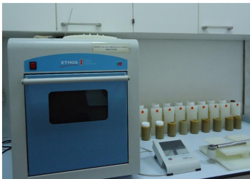
Slika 5.1 Mikrotalasna pećnica ETHOS 1, Milestone, Italija
