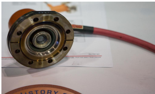
Slika 3.10: Elektronski top triodnog tipa [33]
