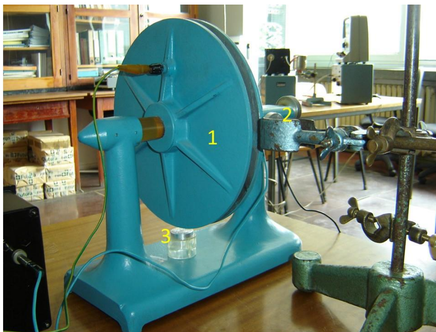
Слика 8. Мерење зависности времена пражњења кондензатора од присуства бета извора: 1- електрични кондензатор , 2 и 3 – извори бета честица
