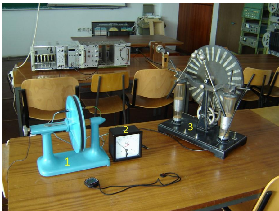
Слика 4. Изглед апаратуре у првој поставци огледа: 1- електрични кондензатор , 2- волтметар , 3- Уимшерстова електростатичка машина
