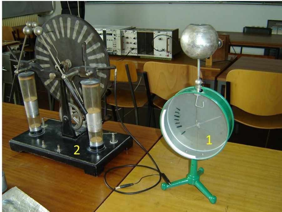
Слика 5. Изглед апаратуре у другој поставци огледа: 1- Браунов електрометар , 2- Уимшерстова електростатичка машина
