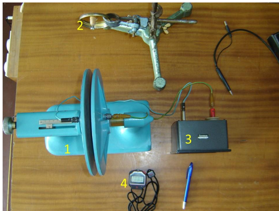
Слика 6. Зависност времена пражњења кондензатора од растојања алфа извора при фиксном растојању облога кондензатора: 1- електрични кондензатор , 2- извор алфа честица , 3- волтметар , 4- штоперица
