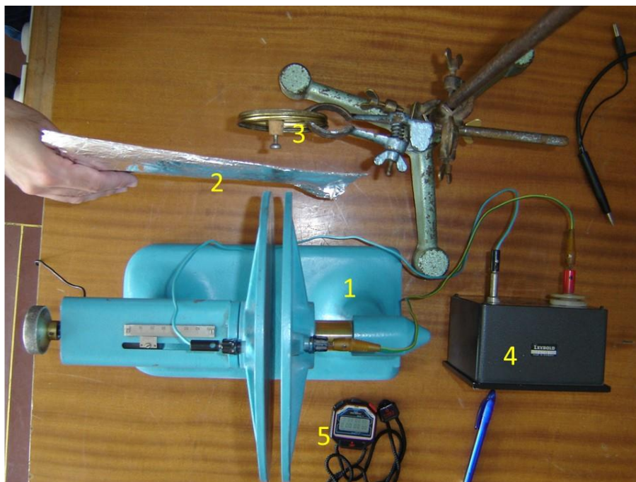
Слика 7. Мерење атенуације алфа честица: 1- електрични кондензатор , 2- алуминујмска фолија , 3- извор алфа честица , 4-волтметар, 5- штоперица
