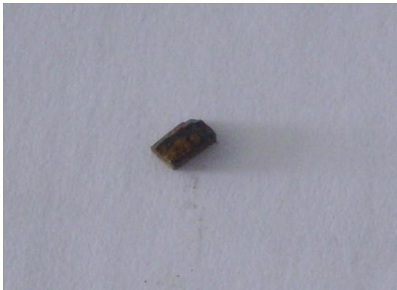
*Slika 6.2. Fotografija uzorka sa 5 at% Fe*
