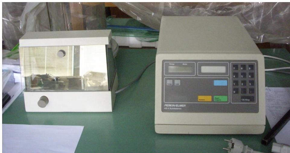
Slika 6.3. Analizičke terazije PERKIN-ELMER, AD-4 Autobalance korišćene u eksperimentu
