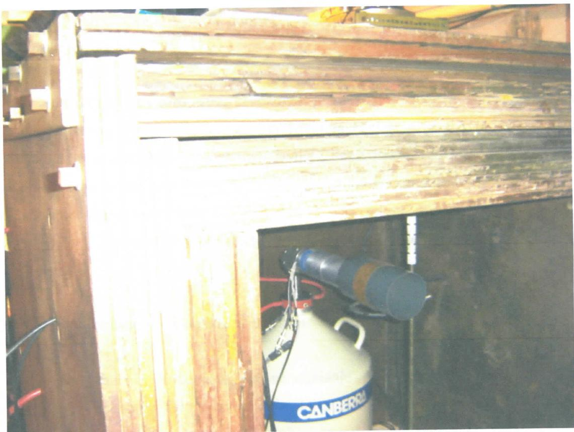
*Slika 8. HPGe detektor u gvozdenoj zaštiti*
