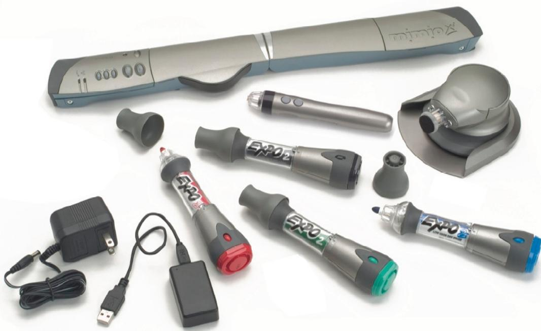
Montirana interaktivna tabla (senzor) registruje signale specijalne olovke (stylus pen) u trenutku dodira površine. Olovka šalje 87 signala svakog sekunda, putem ultrazvuka i infra-crvene komunikacije. Od senzora signal stiže u računar, koji ga obrađuje, tumači i odgovarajući odgovor šalje do uređaja za prikazivanje slike (monitor, projektor).
