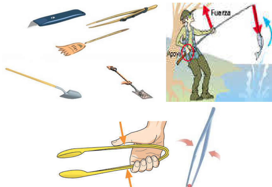
Слика 17. Примери једнострани полуге другог типа
