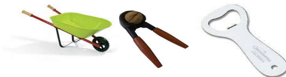
Слика 15. Примери једностране полуге првог типа
