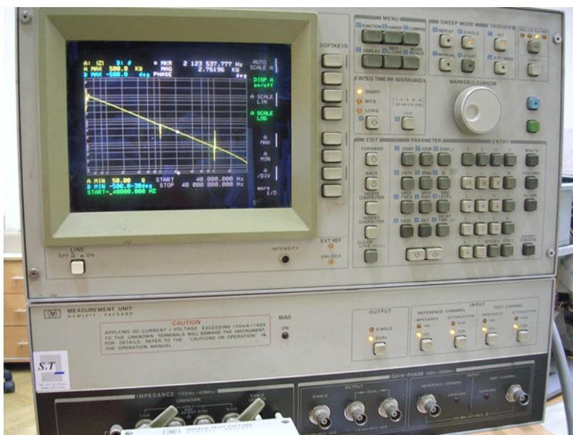
Slika 4.15. Aparatura za merenje *ac* provodljivosti
