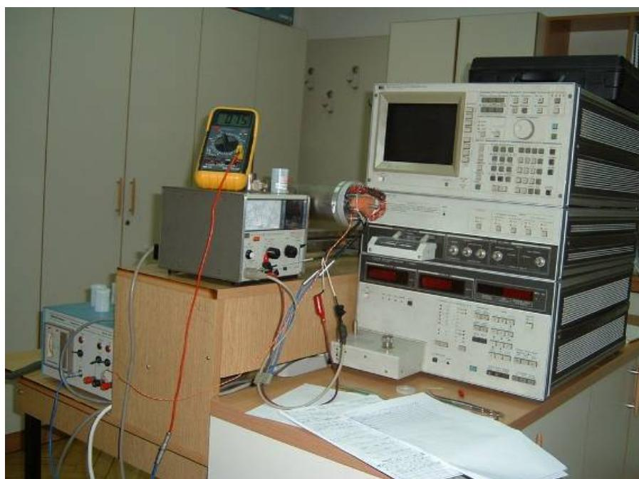
Slika 4.7. Aparatura za merenje *dc* provodljivosti
