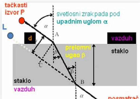
**Slika5** Prelamanja svjetlosnih zraka kroz planparalelnu ploču
