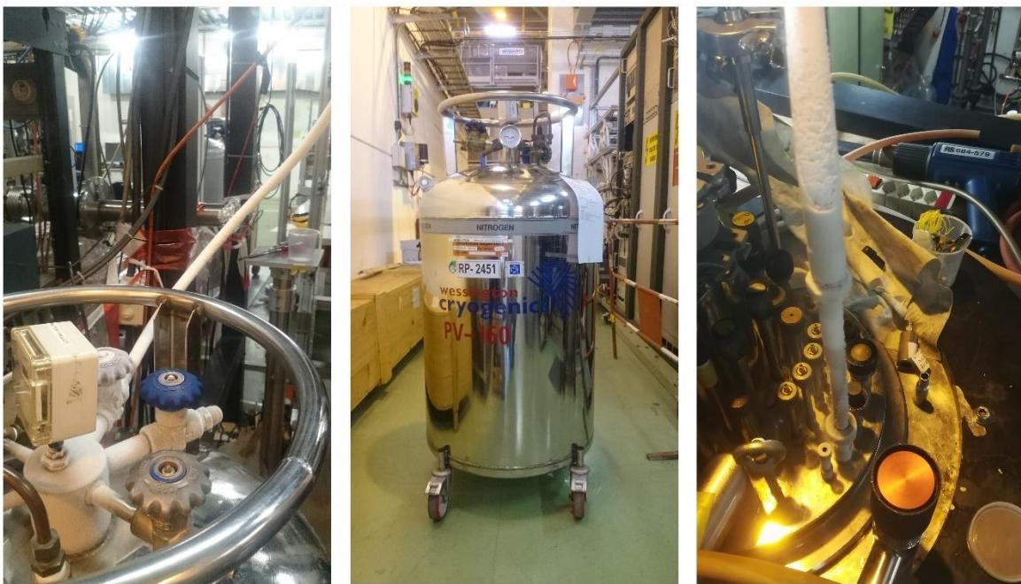
*Slika 59:* Proces punjenja "Main Bath"-a tečnim azotom; Na slici su prikazani: djuar sa tečnim azotom (srednja slika), kuplovanje na djuarov ventil (leva slika) i kuplovanje na azotov ulaz ("Nitrogen Inlet") "Main Bath"-a.
