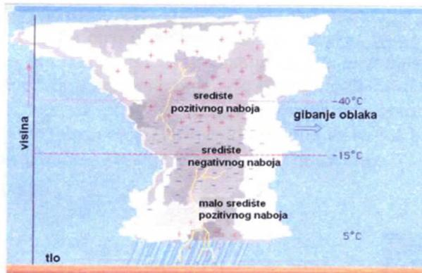
Sl. 3.16. Primer raspodela električnog nanelektrisanja u grmljavinskom oblaku kumulonimbus-u, sa snažnom ćelijom negativnih nanelektrisanja u srednjem delu oblaka i s dve ćelije pozitivnog nanelektrisanja, od kojih je donja slabo razvijena
