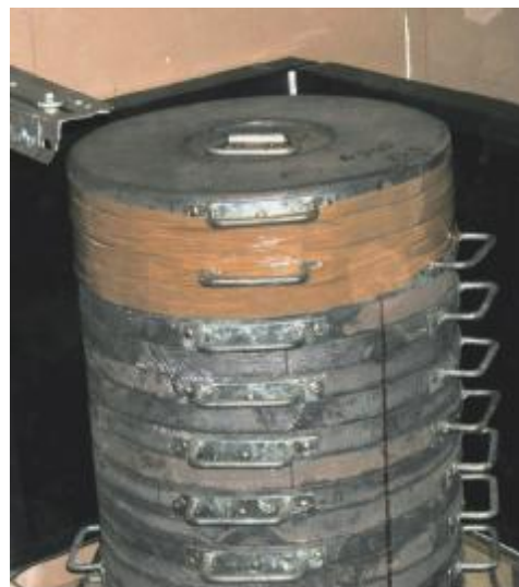
Slika 6.1.2. : a) Poprečni presek Ge detektora relativne efikasnosti 32%, sa odgovarajućom olovnom zaštitom
