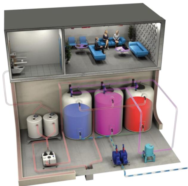
Slika 11. Prikaz sistema bazena za raspad tečnog radioaktivnog otpada postavljenog u suterenu (podrumu) ustanove [44].
