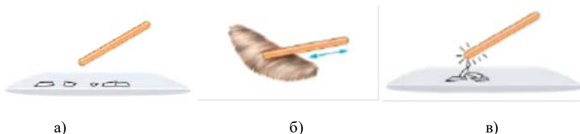
Слика 4.1. Наелектрисавање тела трењем
