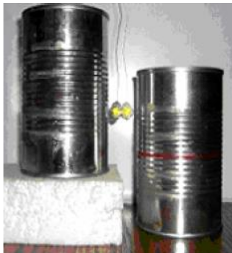
Слика 4.18. Наелектрисавање и разелектрисавање лоптице између лименки
