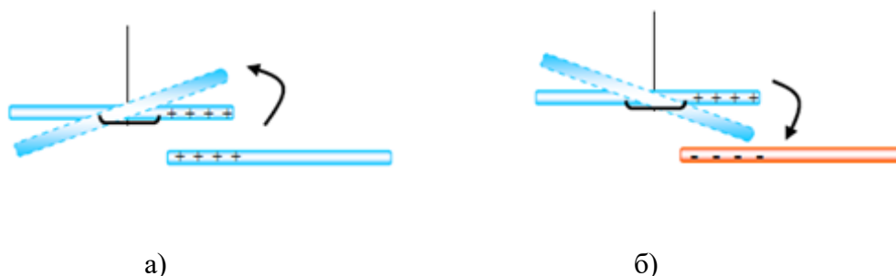
Слика 4.2. Одбијање истоимених наелектрисања (а), привлачење разноимених наелектрисања (б)
