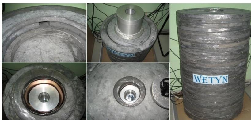
Slika 4.2: Postavka zaštite detektora [23]
