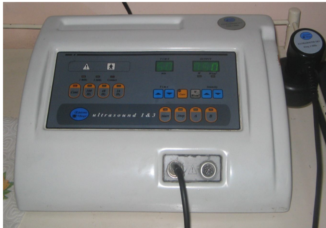
Slika 2.3. Model aparata koji radi na principu impulsnog ultrazvuka
