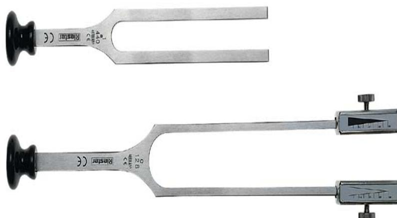
Slika 4.1. Zvučne viljuške za ispitivanje sluha
