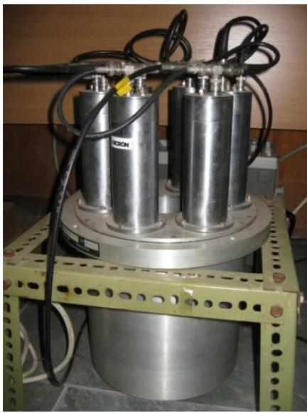
Slika 15 – Izgled anularnog NaI detektora
