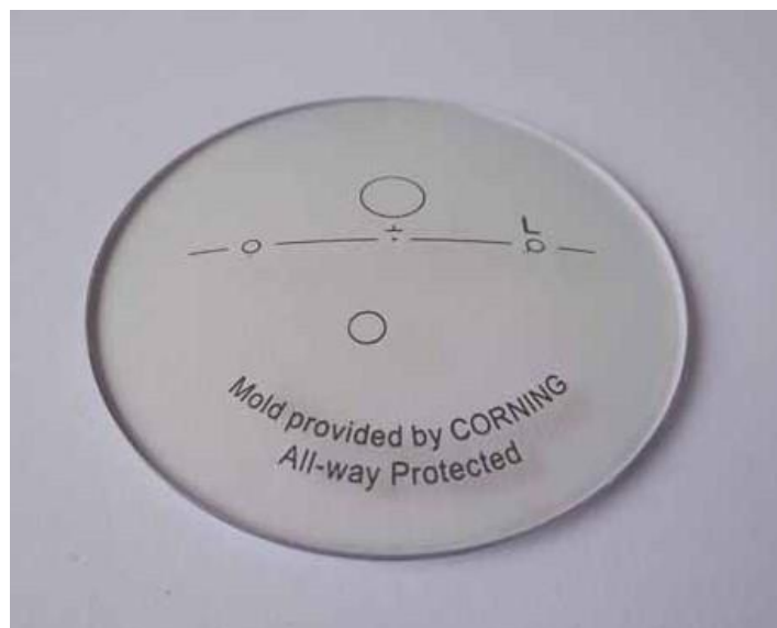
Slika 32. Progresivno sočivo izradjeno od materijala CR-39
