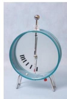
Slika 8. Elektrometar
