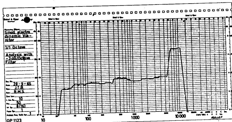
Slika 7.6.4 Spektar vibracija istog izvora dobiven pomocu banke oktavnih filtera. Vidljiv je pad rezolucije koji se ogleda u gubitku pojedinosti.
