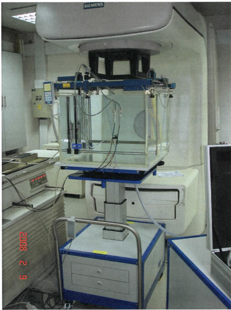
*Slika 17. Prikaz postavke opreme za skeniranje fotonskih polja zračenja. Blue Phantom na postolju sa ionizacnim komorama CC13.*
