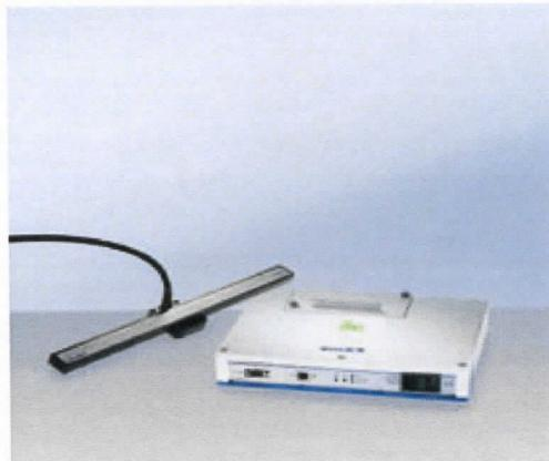
Slika 15. LDA-99 SC i elektrometar emXX
