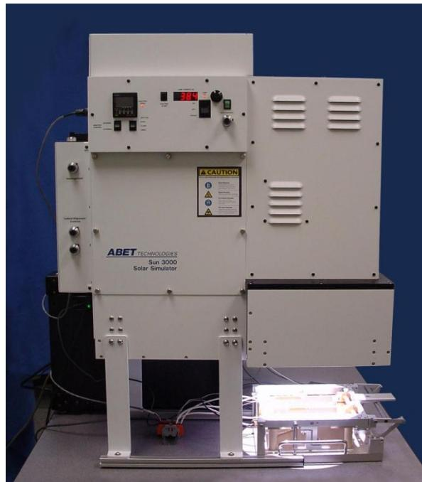
Slika 5.2. Model # 11018 Solarnaog simulatora
