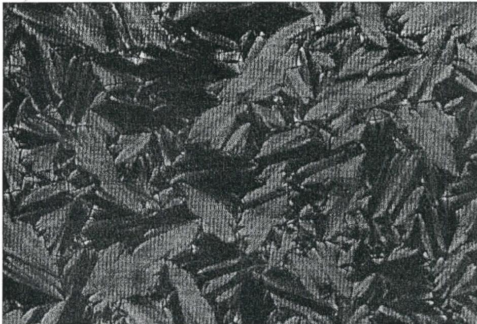
SLIKA 9: Lepezasta tekstura SmA za 4 - n-oktiloksibenziliden-4-hloroanilin, 96°C, ukršteni polarizatori
