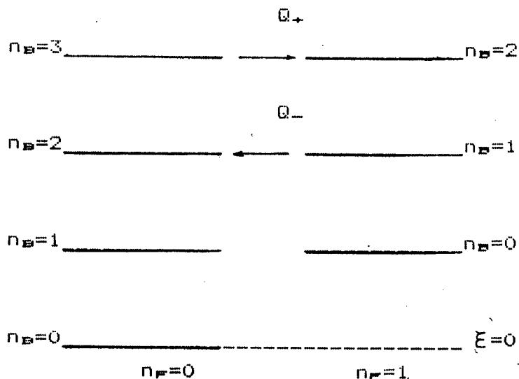
sl. 1 Energetski spektar supersimetričnog oscilatora
