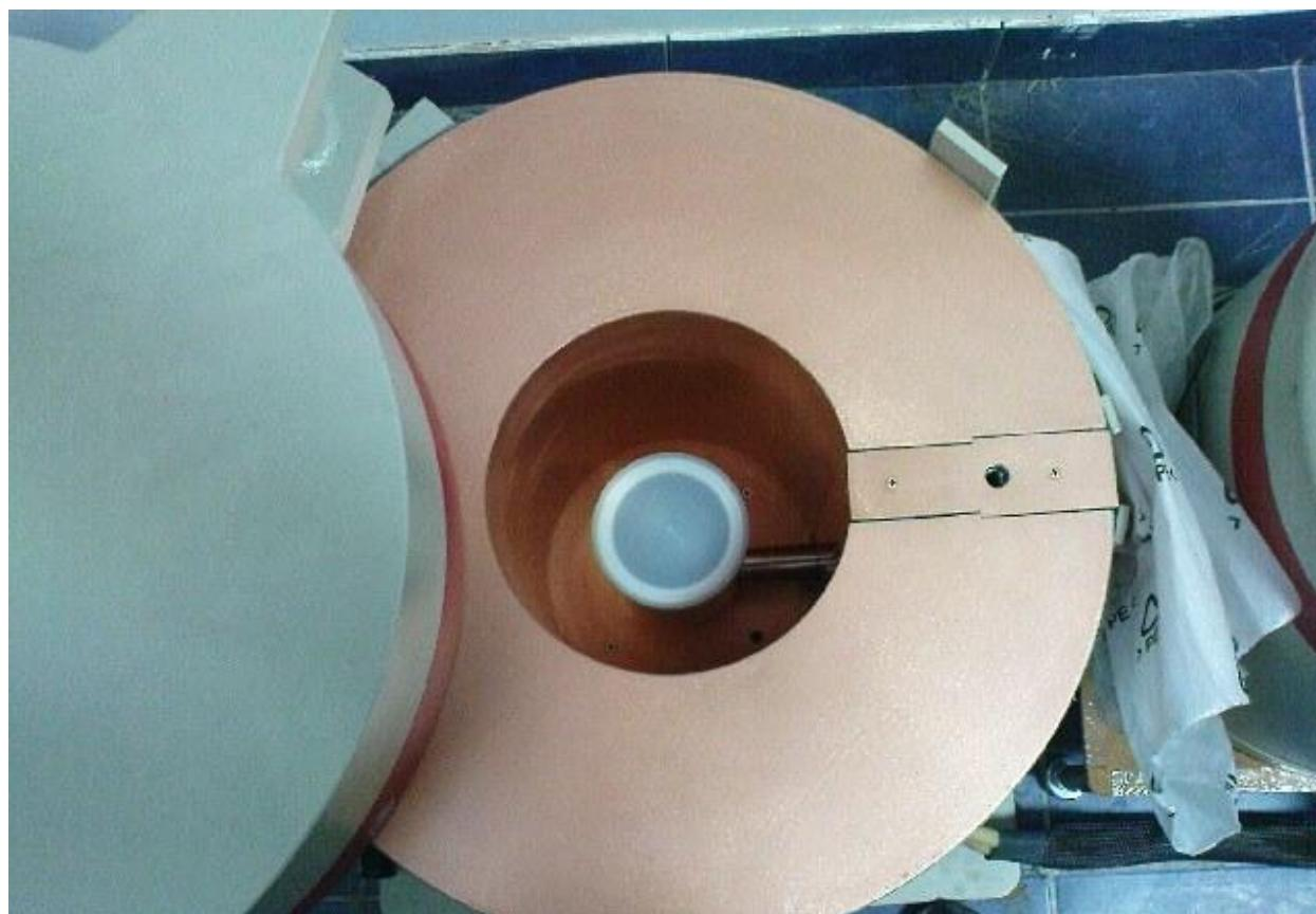
*slika 4 - Ge detektor u Pb zaštiti (100% Ge detektor u komercijalnoj zaštiti proizvođača Canberra, oznake B u Laboratoriji za nuklearnu fiziku u Novom Sadu)*
