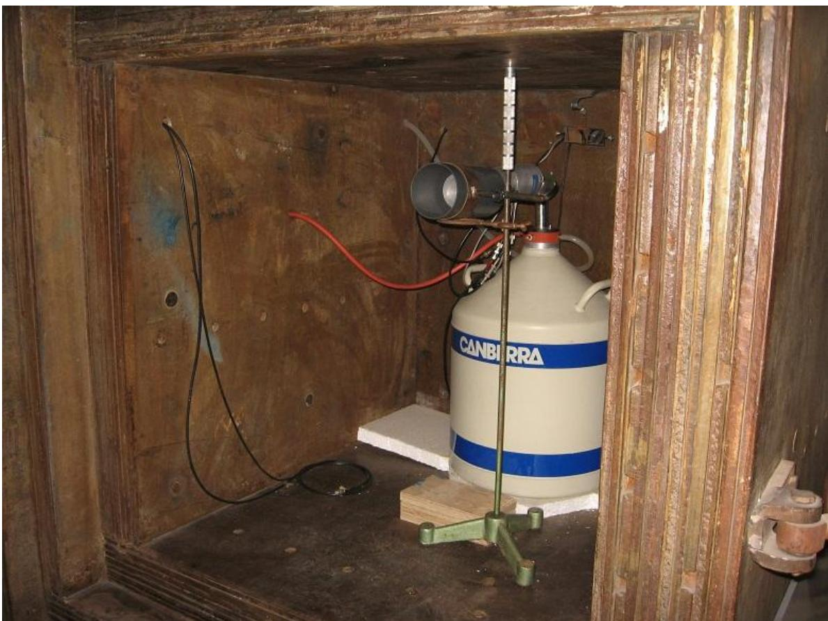
Slika 14. - Ge detektor u Fe zaštiti u Laboratoriji za nuklearnu fiziku, Novi Sad
