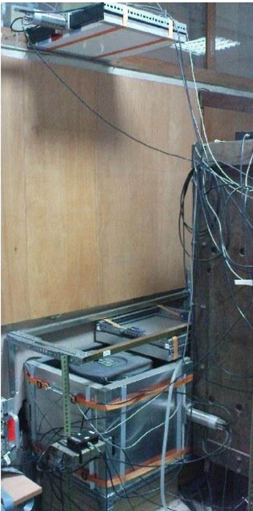
*slika 6 - Ge detektor okružen plastičnim detektorima - primer sistema aktivne zaštite detektora ( L detektor u Laboratoriji za nuklearnu fiziku u Novom Sadu)*
