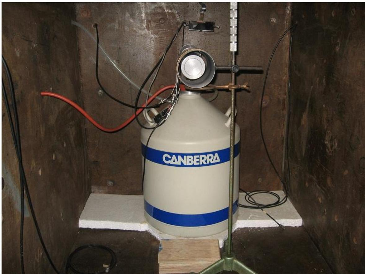
Slika 15. - Ge detektor u Fe zaštiti
