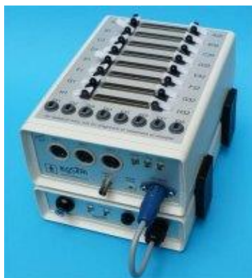
Slika 31. AD-box sa baterijama (256 kanalni).
