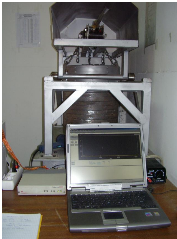
Slika 8. Germanijumski detektorski sistem korišćen u merenju
