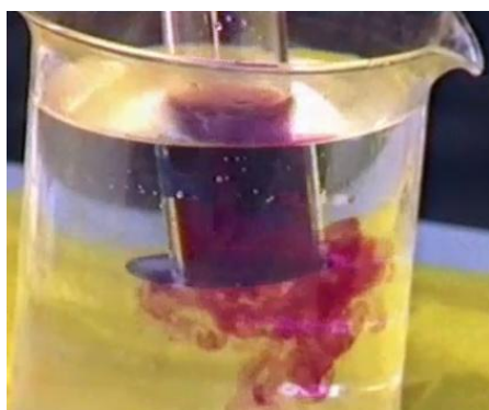
Слика 49. Утврђивање особина хидростатичког притиска
