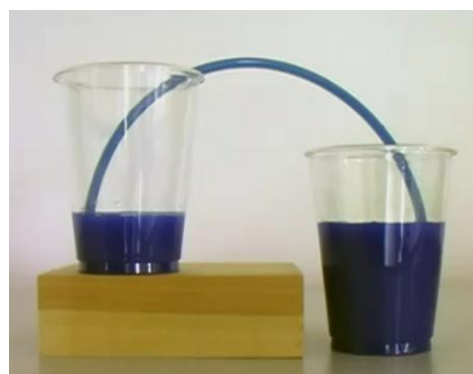
Слика 49. Утврђивање особина хидростатичког притиска
