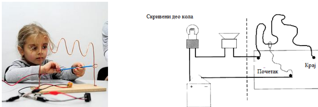
Слика 65. „Електрична рука“ ; шематски приказ „Електричне руке“
