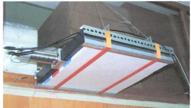
Slika 5.1.4: Plastični scintilacioni detektor korišćen tokom eksperimenta
