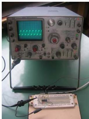
Slika 9.6. Merenje vremena propagacije signalova TTL kola
